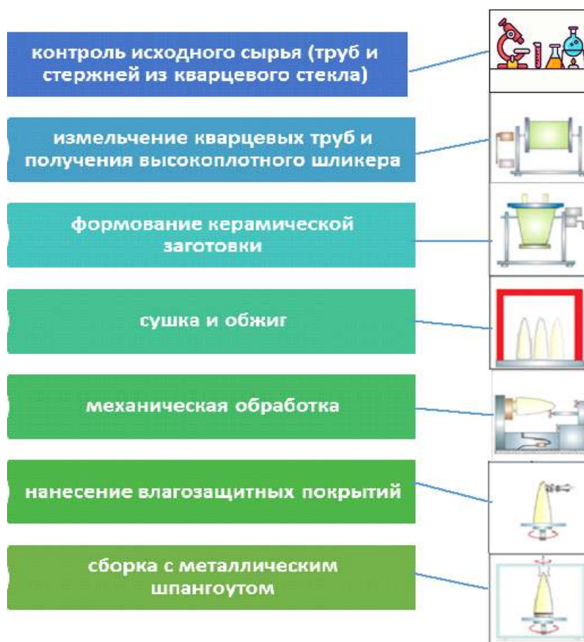
Рисунок 1.2. Схема изготовления обтекателей из кварцевой керамики.
