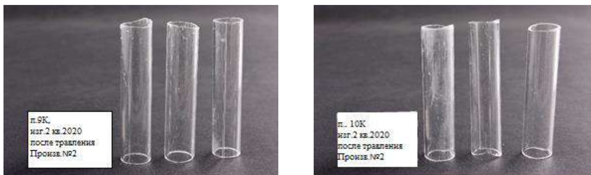
Рисунок 4.5 - Внешний вид труб партий №№ 9К и 10К (производителя №2) после испытаний на устойчивость к кристаллизации.
