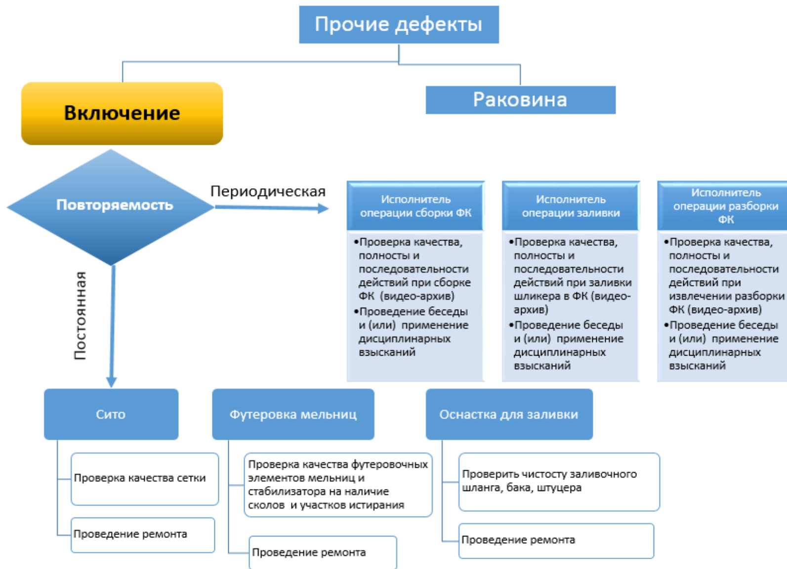
Рисунок 6.6 – Схема алгоритма поиска причины образования включения.
