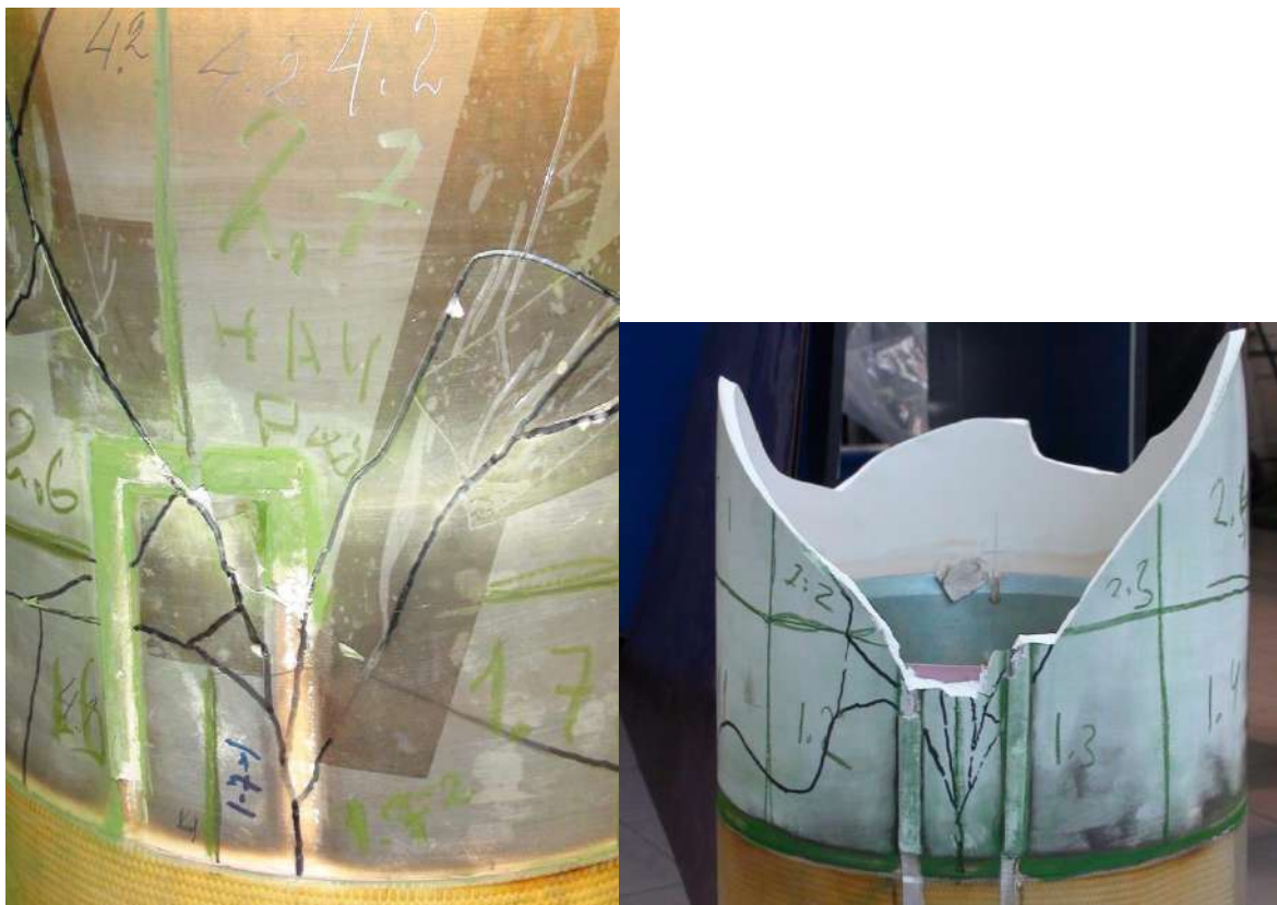
Рисунок 3.1. Разрушенный керамический обтекатель.
