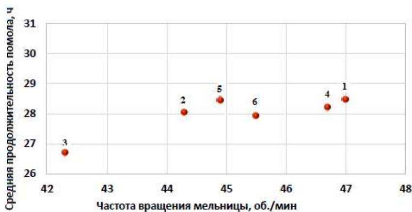
Рисунок 4.13 – Средняя продолжительность помола кварцевого стекла в зависимости от частоты вращения мельниц за 01.2017 – 07.2020 гг.
