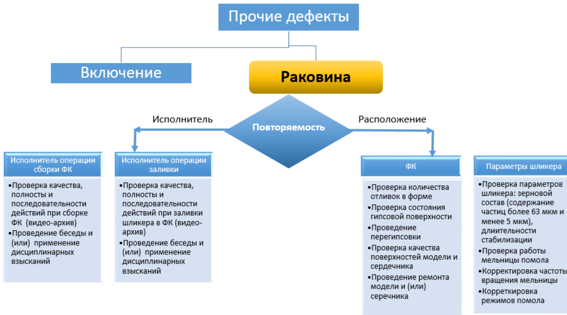
Рисунок 6.7 – Схема алгоритма поиска причины образования раковины.
