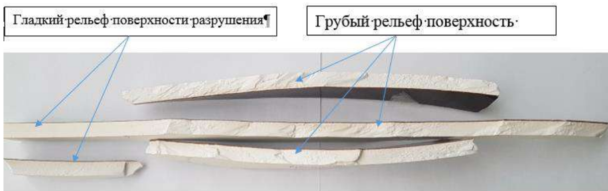
Рисунок 3.5 - Фрагменты заготовки с гладкой и грубой поверхностью разрушения.
